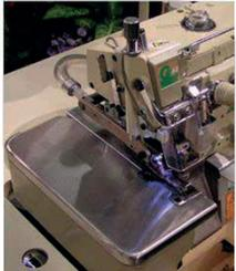
CORTADOR NEUMÁTICO DE CADENA K1
