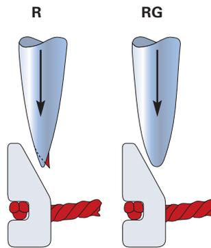
Por la geometría del cuerpo de las puntas RG, adaptadas al ángulo del bisel de la lanzadera y la punta ligeramente redonda de las RG, estas permanecen mucho más tiempo de trabajo sin daños.
