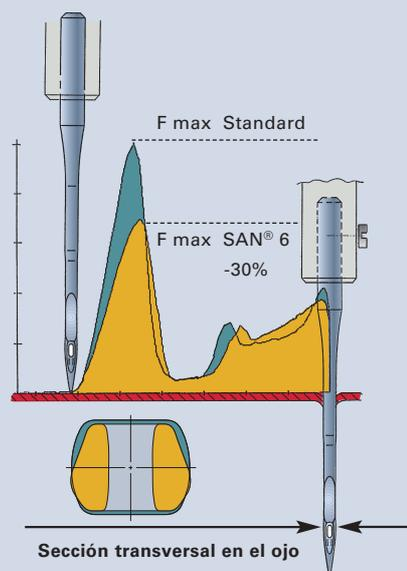
**La fuerza de penetración (F max) se reduce hasta un 30%, según el sistema de aguja, comparando con agujas standard.**
