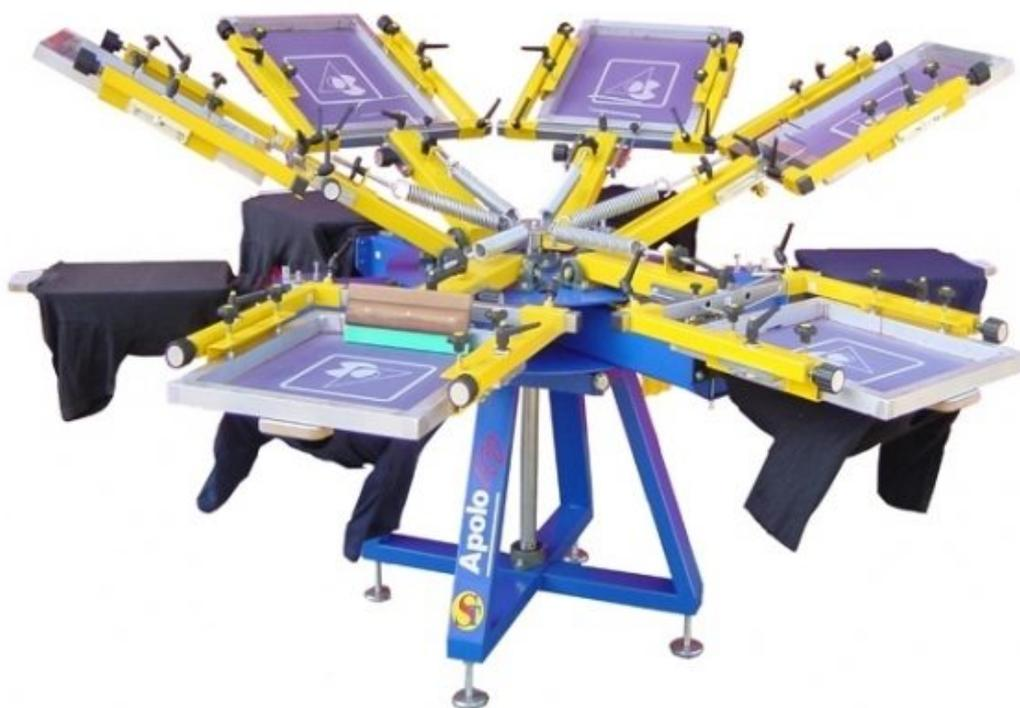
**APOLO PRINT** es un carrusel manual de impresión textil equipado con micro registro de impresión. Tiene la capacidad de instalarle varios palets especiales como: sombrillas, mangas, chamarras, tapas, palet de succión.
