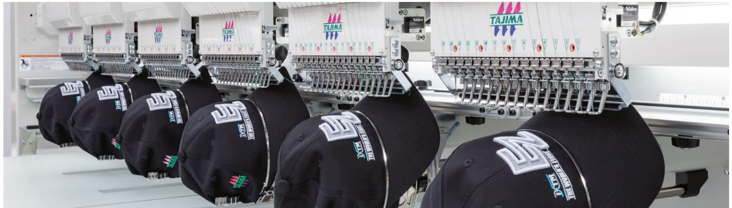
El refuerzo de la estructura de soporte del bastidor de gorras ha contribuido a la estabilización del acabado del bordado, aumentando drásticamente la velocidad máxima de rotación hasta 1,000 R.P.M.
