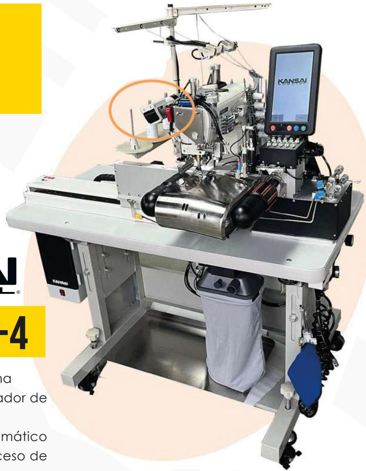
**Control de sensores:** Se utilizan varios sensores para controlar la costura con precisión, para una costura uniforme y con excelente calidad.
