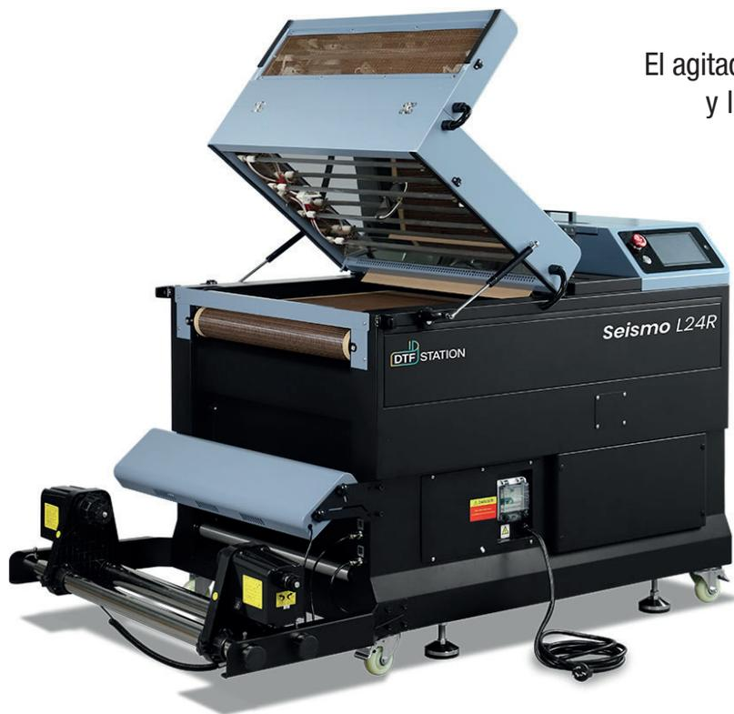
El agitador está controlado por un sistema de sensores inteligente y los usuarios simplemente deben asegurarse de reciclar la tinta y el polvo cada 4 horas durante el funcionamiento.
