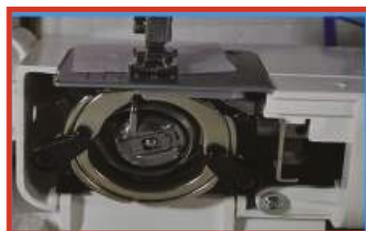
Bobina vertical metálica
