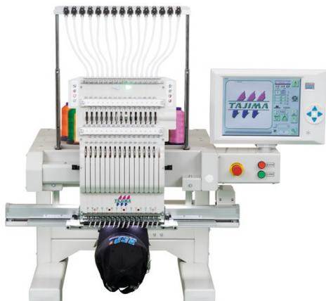
Es una innovadora máquina de bordar sin ajuste manual de la tensión del hilo. **i-TM (Intelligent Thread Management) Detecta automáticamente la altura del material.** Brinda un bordado más suave.
