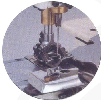
Incluye aparato para dobladillar. Máquina con corte de hilo y motor electrónico.
