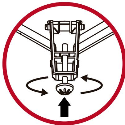
Altura regulable mediante giro
